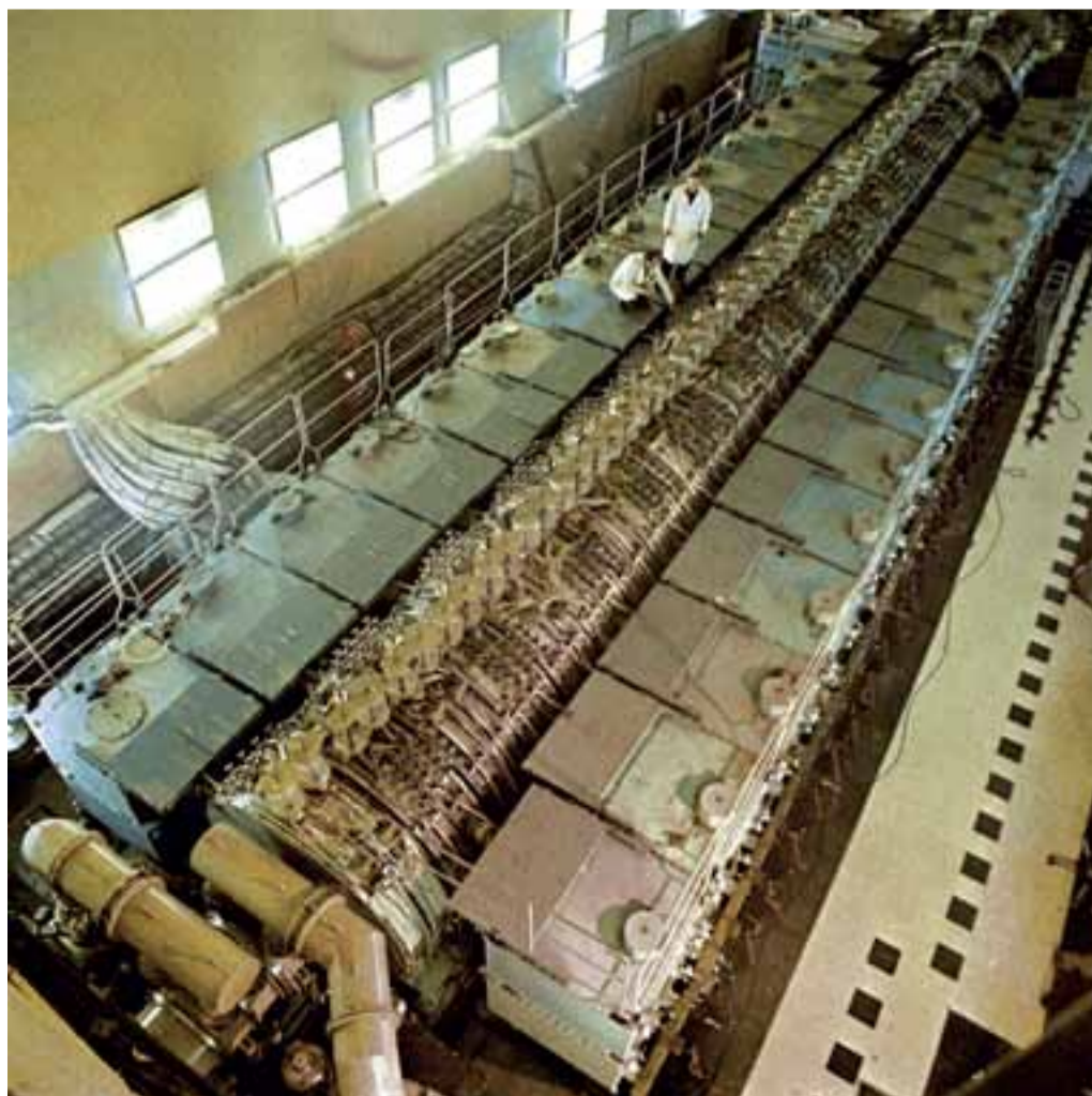
Комплекс ПУЛЬСАР Ускоритель ЛИУ-30
